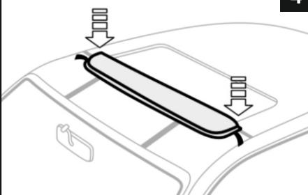
Rimuovere 5 cm di strato protettivo del nastro adesivo da ciascuna estremità del deflettore del tettuccio apribile. Durante l'installazione, fare attenzione a non toccare la superficie adesiva del nastro con le mani!
