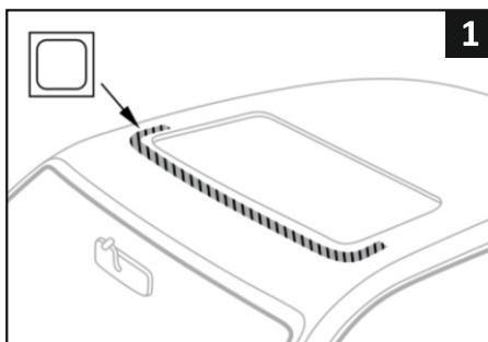
Lave y seque el techo por completo. Limpie el lugar de instalación del deflector para techo solar con una toallita con alcohol.
